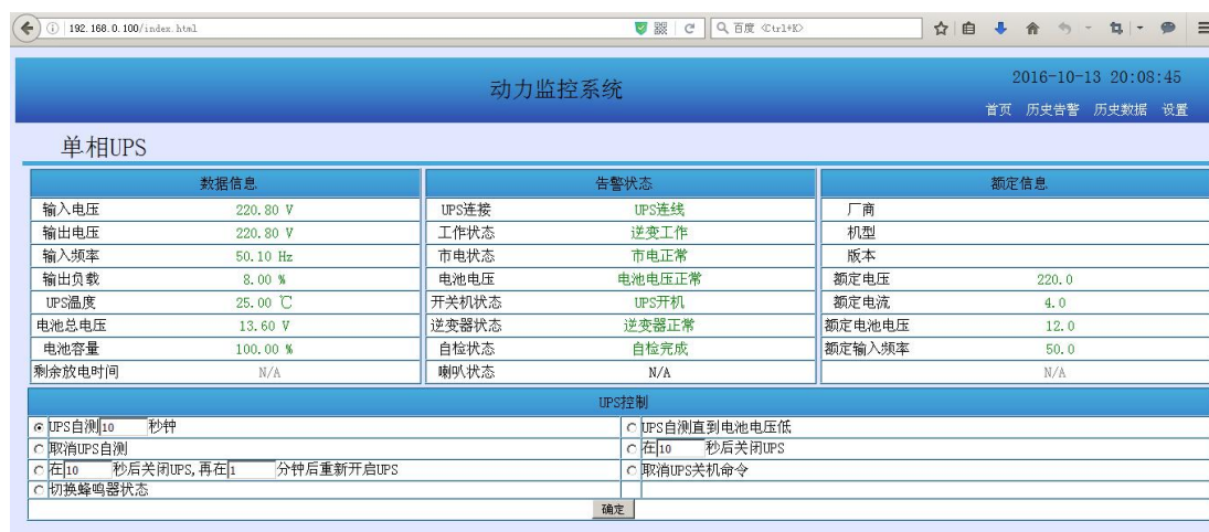
UPS 监控界面
